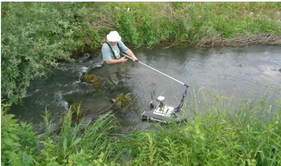
Slika 33. Izvedba meritev z opremo Sontek z ročnim upravljanjem.
