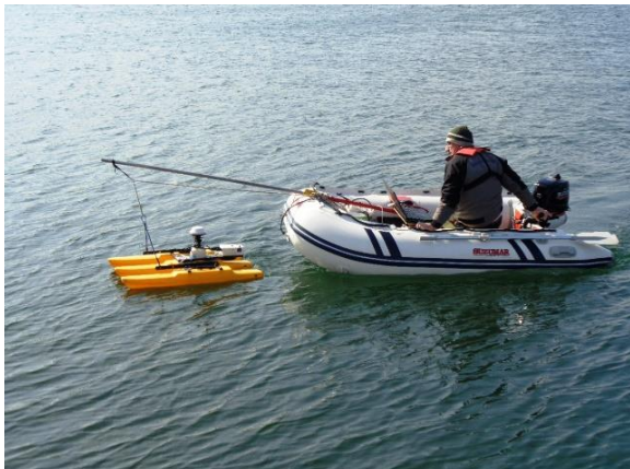
Slika 3. Meritev hitrostnega profila z akustičnim merilcem na akumulaciji Brežice
