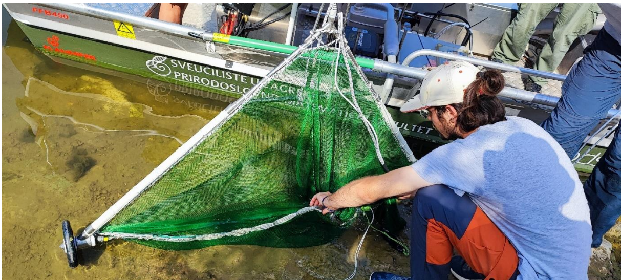
Slika 18. Električna pridnena vlečna mreže E-KECE uporabljena pri elektro-izlovu v akumulaciji (foto: G. Urbanič)
