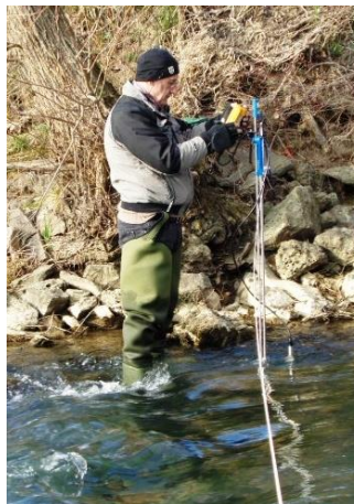
Slika 4. Meritev hitrostnega profila z ročnim akustičnim merilcem
