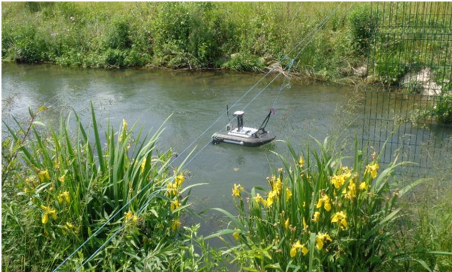
Slika 32. Izvedba meritev z opremo Sontek z vrvmim upravljanjem.
